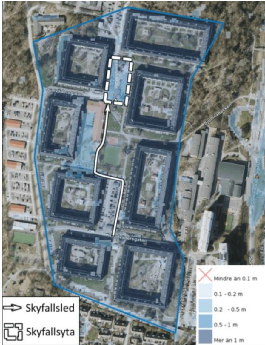
Figur 9: Beräknad översvämning vid skyfall (100-årsregn) för befintlig situation. Figuren visar även planerade strukturplansåtgärder i närheten av planområdet i form av en skyfallsled som ska styra ytflöden till en skyfallsyta. Planområdet är markerat med blå linje (Stadsbyggnadsförvaltningen, u.d.).
